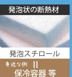
断熱材はたくさんの“空気”的層からなります。空気は熱の伝わりが遅いので、空気の層が多いほど熱の伝わりが遅くなります。このため断熱材は厚さが増すごとに断熱性能が高くなります。断熱材と聞くと「熱を止めるもの」と思われますが、正確には「熱の伝わりを遅くするものです」。熱の伝わりを遅くしながら熱を吸収し保温します。
